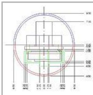
直径約2cmの球形。転がすとLEDを上にして起き上がるようにデザインされています。
