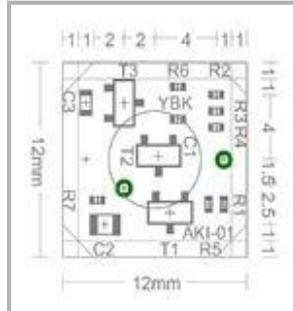
昇圧回路によりLEDをフラッシュ発光。チップ部品を採用し、超軽量・小型を実現。
